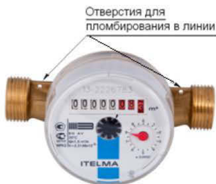
Рисунок 1 Внешний вид и места пломбирования счетчиков
